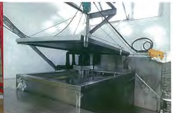
④-3 アルコールブライン凍結器 (1 バッチ 100kg)
