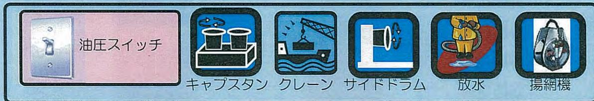
改革後 油圧系統を**3つに分ける**→状況によって必要なものだけを作動させる。
