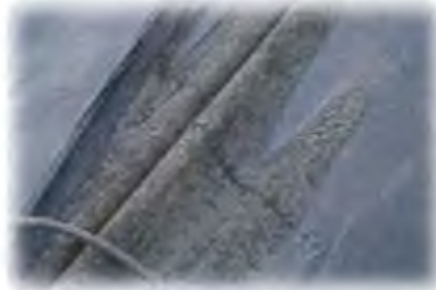
網目が塞がるほどの付着物 (現状の目合16節)
