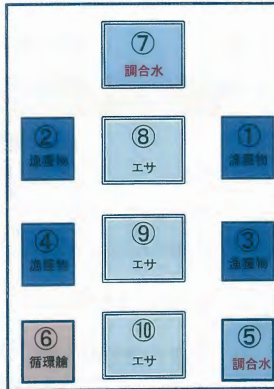
【作業中の魚艙状態】
