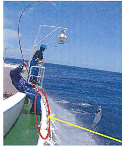
釣台からの転落防止用スネあてを設置。 大型化により釣人の間隔が広くなり漁労作業時の安全性がさらに確保される。
