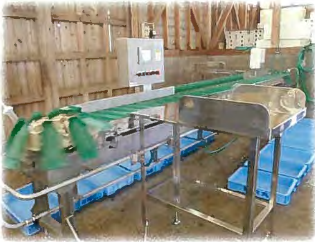
①手前の銀色の部分が魚の供給台
