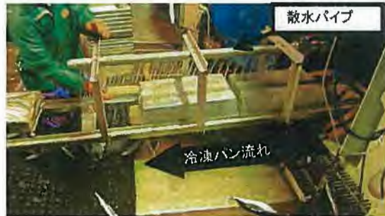
急速冷凍庫から1ケースずつ取り出し、冷凍パンに海水を掛けることで脱パンをしやすくする
