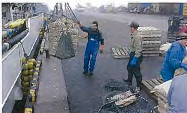
凍結製品専用の水揚げモッコを3~4枚を用意し、そのモッコに20 ケース程度を入れて、船内クレーン(ポンプ)を使用して揚げた。 水揚げ速度は1,000ケース/時程度であった。 5枚9段でパレットに積み、大型冷凍庫に凍結保管した。
