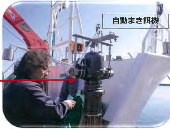
遠隔操作により上下左右への動作が可能
