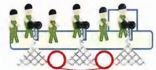
キャッチホーラー方式の網起し図
