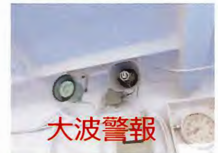
③大波警報を船尾へ設置
