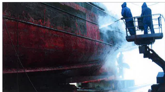
清水高圧洗浄清掃
