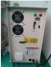
高性能活魚設備 （酸素供給装置）
