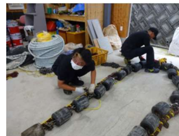
底びき網のグランドの構成 と修理の研修
